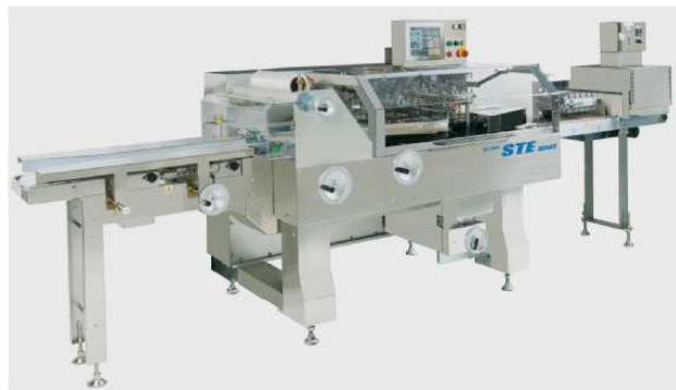
プラスチック製フィルムの使用量を3割削減できる食品トレー用包装機
